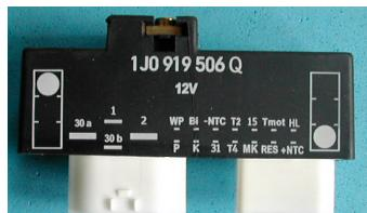
**Cooling fan control module:****18 Pins**
