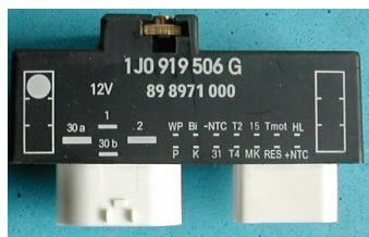
**Cooling fan control module:****18 Pins**
