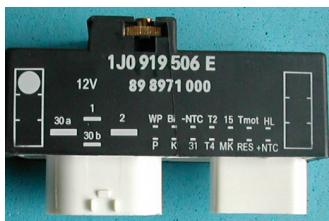
**Cooling fan control module:**
