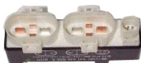
**Cooling fan control module:****12 Pins**
