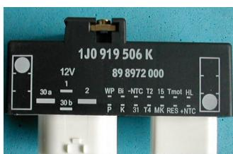
**Cooling fan control module:**
